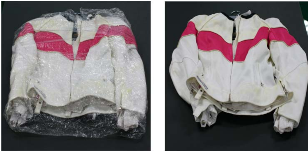
<그림 3-2> 포장재의 BHT와 NO x 에 의한 황변
