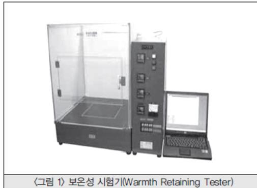
〈그림 1〉 보온성 시험기(Warmth Retaining Tester)
