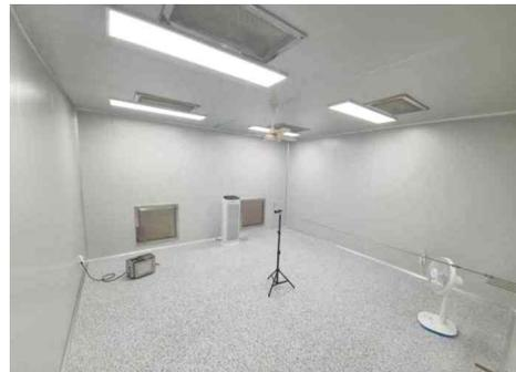
KOTITI시험연구원 시험 챔버 (30 m<sup>3</sup>, 50 m<sup>3</sup>)
