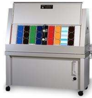
그림 1. Q-LAB社 QUV 내광성 시험기
