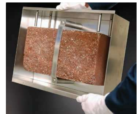
그림 2. 3D 박스 시험편 홀더
