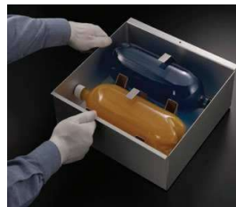
그림 2. 3D 박스 시험편 홀더
