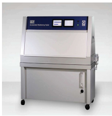
그림 1. Q-LAB社 QUV 내광성 시험기
