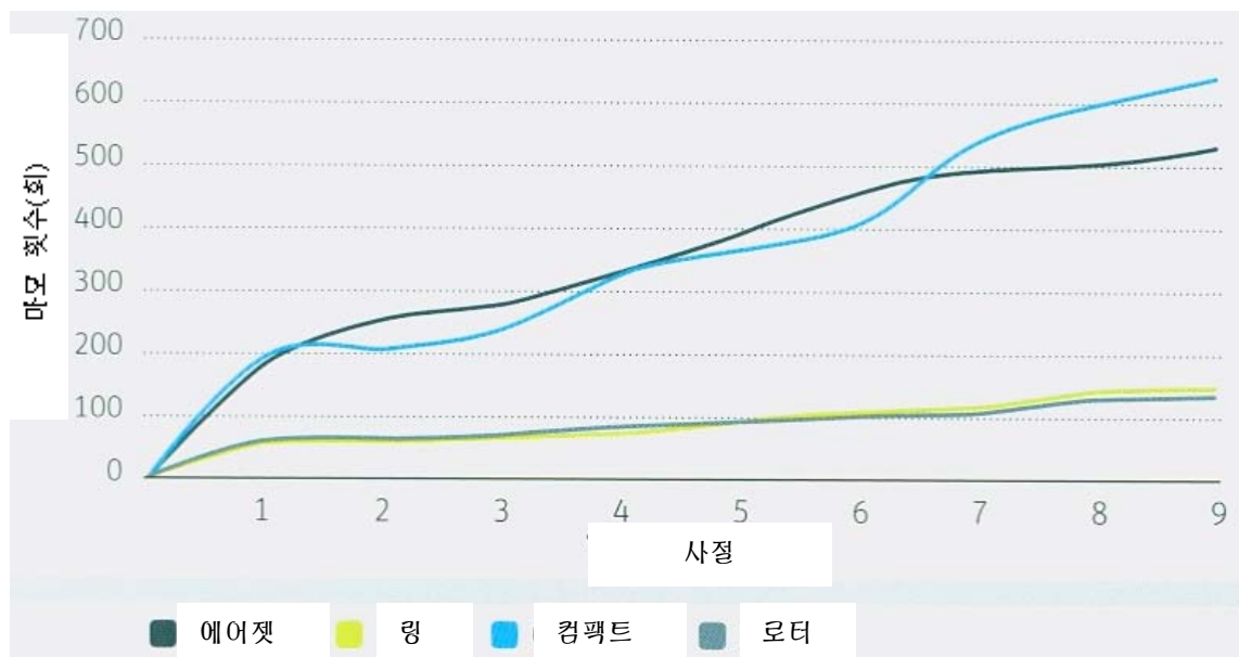
<그림 14> 텐셀® LF/면(50/50) 혼방사의 마모 저항성(20 tex, Reutlinger Webtester)
