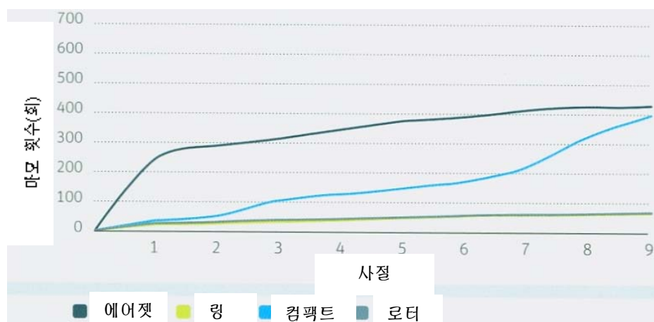
<그림 16> 텐셀® LF/면(67/33) 혼방사의 마모성 저항성(20 tex, Reutlinger Webtester)
