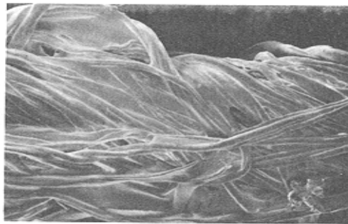
<그림 6> 전분으로 가호된 면사의 주사형 전자현미경 사진(160배)
