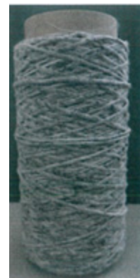
〈그림 5〉 리사이클 탄소섬유 마찰 방적사 (400 ~ 2,000 tex)
