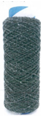
〈그림 6〉 리사이클 탄소섬유를 이용한 가공사 (400 ~ 2,000 tex)
