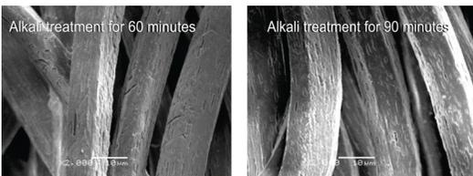
〈그림 7〉 알칼리 감량 가공 시간에 따른 섬유의 SEM 사진
