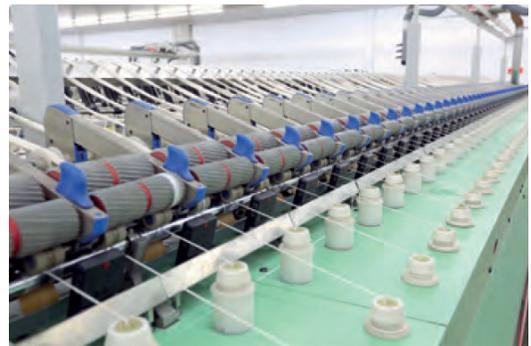
〈그림 4〉 개별 조사 모니터링 시스템은 조사 장력 조절 및 통계 분석시스템의 통합으로 인해 일정한 품질을 보장해 준다.
