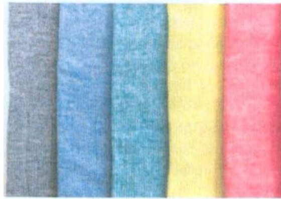
<그림 5> 멜랑지 시료 (미처리 비스코스 85%, Danufil Deep Dye 15%)
