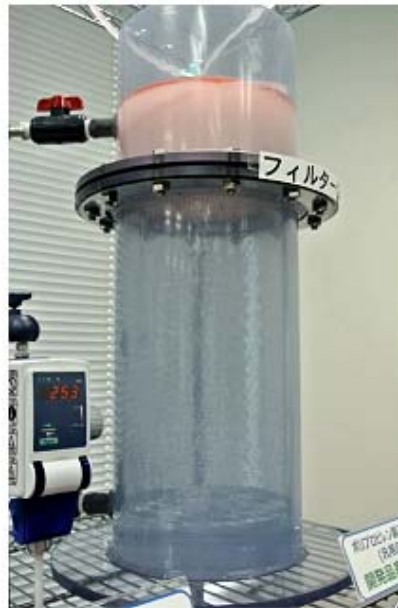
<그림 2> 불소 화합물로 표면 처리한 필터를 사용한 유수 분리 장치
