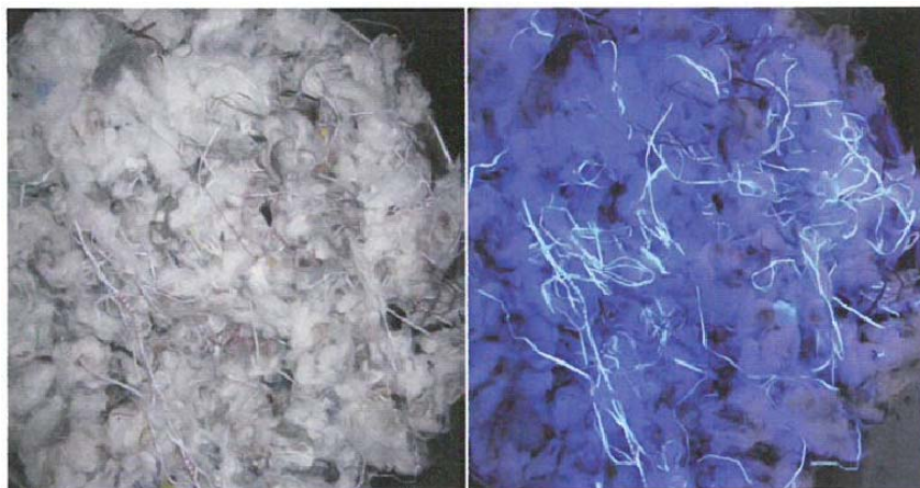
<그림 1> VTECT 시스템은 자외선을 사용하여 형광물질이 있는 이물질을 검출함.
