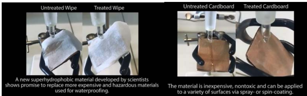
<그림 2> 탄화수소계 재료를 이용한 코팅의 발수성
