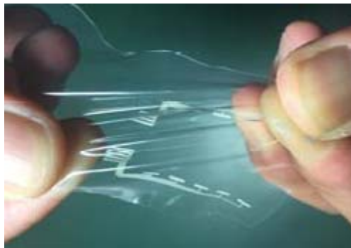
<그림 2> TOYOBO社の 전도성 페이스트로 제작한 신축성 배선
