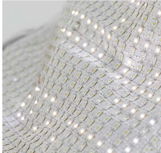
<그림 3> LED 적용 E-textile
