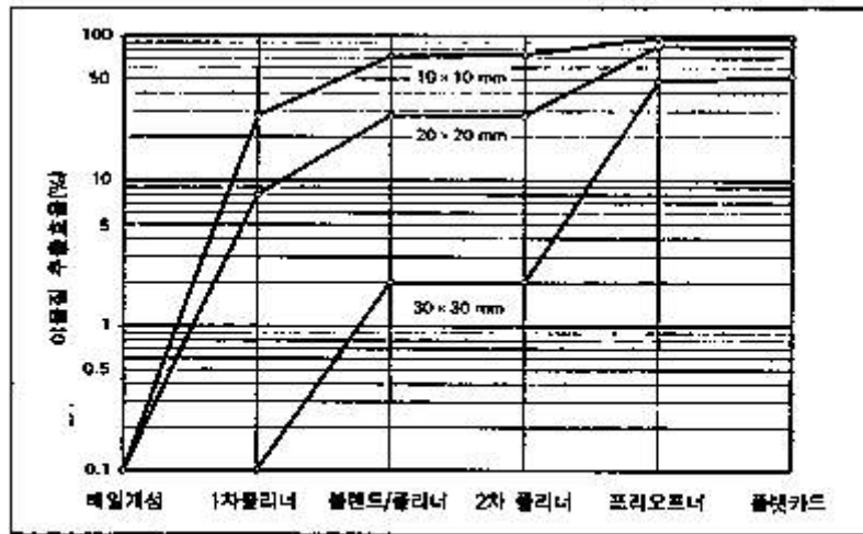
〈그림 2〉 이물질 추출시스템이 없는 기존 혼타면라인에 의한 특정 이물질 추출 효율 (%)
