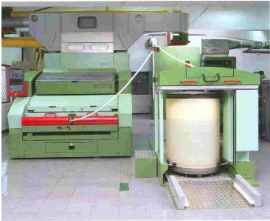
<그림 3> South Pacific Viscose 방적센터에서 가동 중인 C60 소면기
