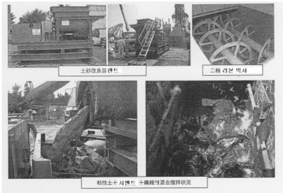
<그림 6> 실제 플랜트에 의한 혼합 시험
