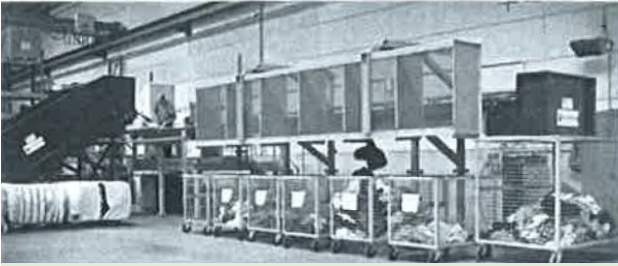
〈그림 2〉 근적외선을 이용한 의류 분별시스템
